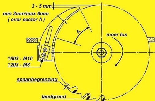
De dikte van het spouwmes moet min. 0,2 mm groter zijn dan de lijfdikte van het zaagblad waarvoor het is bestemd, doch moet kleiner zijn dan de breedte van de zaagsnede.
