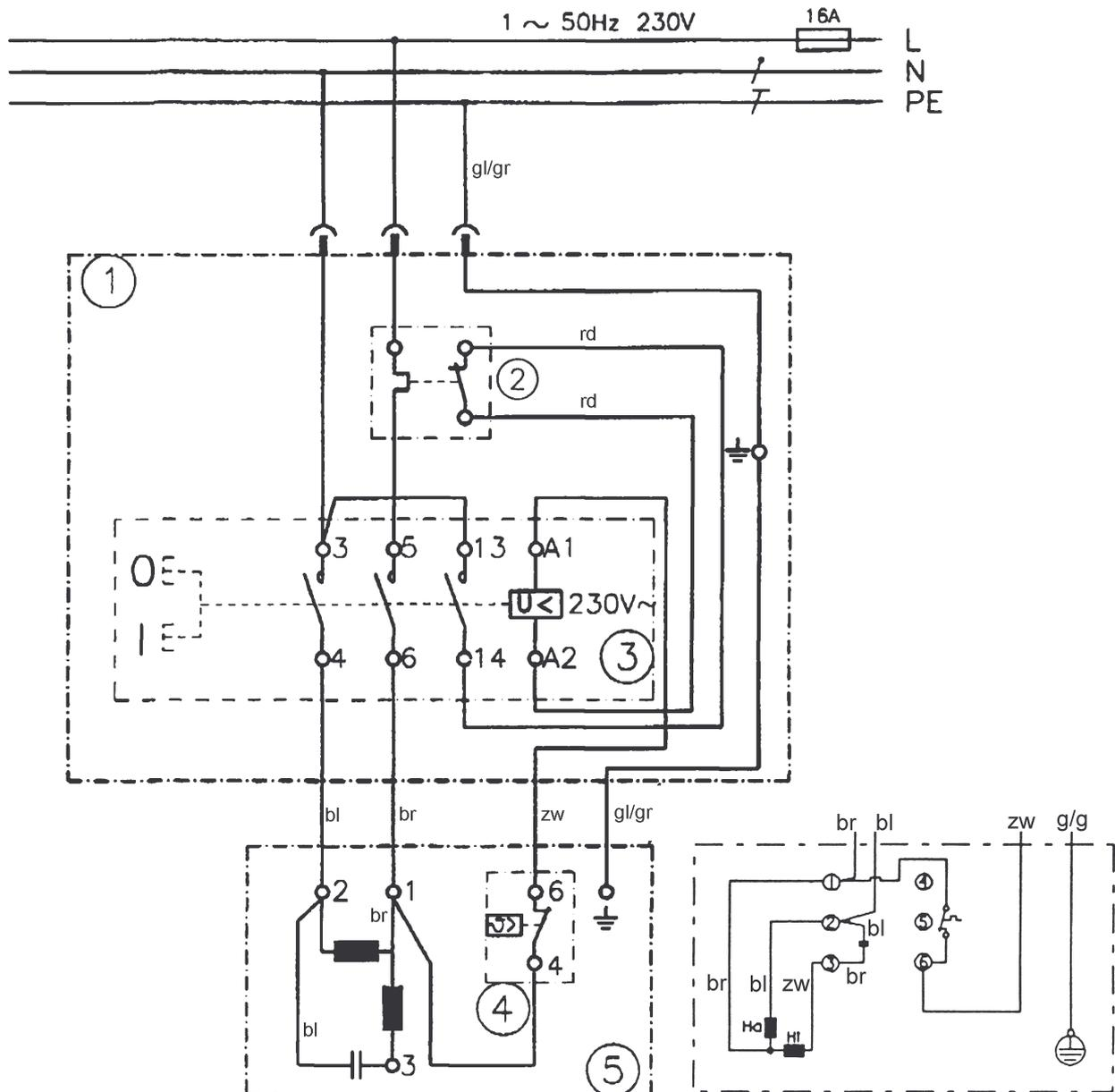
Klem-aansluitschema in motor
